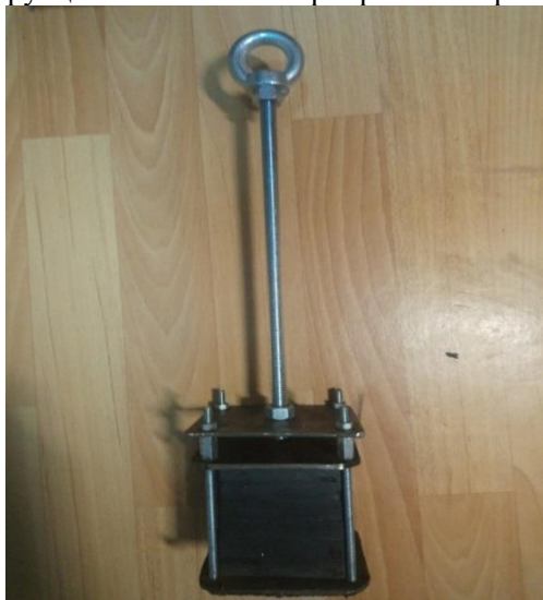
Рис. 3. Блок магнитов сепаратора: 1 – блок магнитов; 2 – пластины; 3 – болты; 4 – пластина; 5 – гайки; 6 – шпилька; 7 – барашек с ушком
